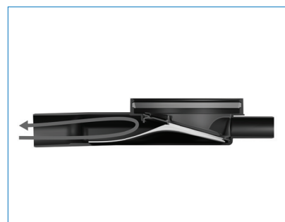
3 Når det ikke renner vann, lukkes membranvannlåsen tett slik at avløpsgasser
